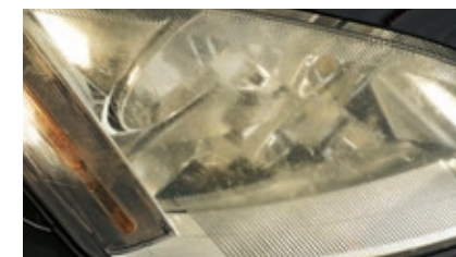
Die Kunststoffscheibe war mal klar und durchsichtig, jetzt ist sie verkratzt und vergilbt
