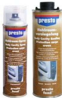
Este sellado de huecos a base de cera y en un aerosol protege sobre todo las cavidades que puedan oxidarse en las carrocerías de los automóviles, por ejemplo puertas, partes laterales, tapa del maletero etc. Con un tratamiento regular se pueden evitar a tiempo los daños por óxido. Es suficiente una capa fina para proteger los metales.
